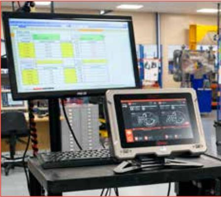
Der T-Box™ 2 nutzt zwei Hochleistungsprozesse zur Bereitstellung und Vervollständigung von Drehmomentdaten im Datenspeicherpaket. Diese ist in der Lage, Werkzeugkalibrierungen, Datenerfassung, gleichzeitige Aufnahmeverbindungen und Archivierung auf Ihrem PC durchzuführen.
