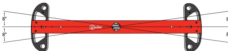
Zusätzlich sind die Balken so ausgelegt, dass die Last auf eine vertikale Ebene aufgebracht wird, die den Vierkantantrieb im Inneren des Wandlers durchschneidet. Dadurch werden Biegemomente auf den Aufnehmer minimiert und für einen sicheren Betrieb wird sichergestellt, dass der Balken nicht aus dem Aufnehmer herausfällt.
