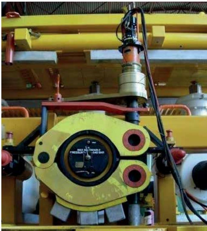
*Unterwasser 63.000 N·m Rohrschellenwerkzeug im Test*
