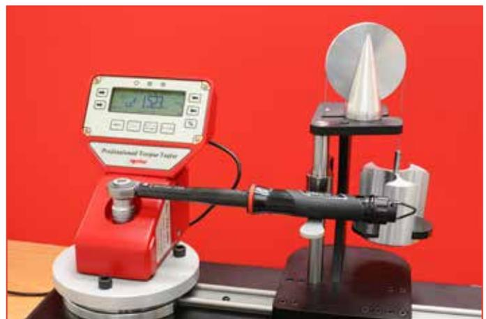
60323 Pro-Test und statisches Drehmomentblock-Adapter-Set
